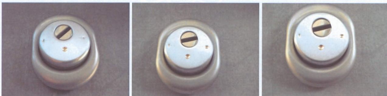
Fotografie delle protezioni del cilindro sottoposte a resistenza ad attacco per trapanatura.
