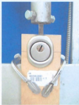
Fotografie delle protezioni del cilindro sottoposte a prova di attacco con scalpello.
